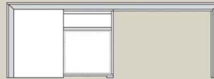
Brücke für Cateringumbau mit Kühlschrank hinter Schiebetür links und Frontauszug mit Abfallbehälter rechts
