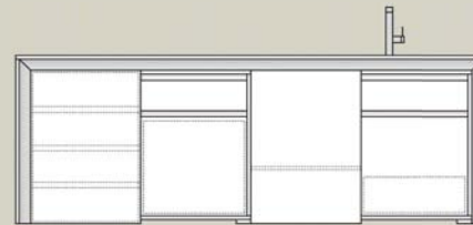
Brücke für Cateringumbau inkl. Oberboden mit Spüle und Armatur
